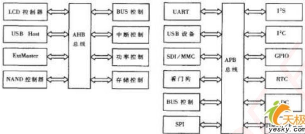
我们需要对上图中的 AHB 总线和 APB 总线的概念进行一番解释。ARM 核开发的目的，是使其作为复杂片上系统的一个处理单元来应用的，所以还必须提供一个 ARM 与其它片上宏单元通信的接口。为了减少不必要的设计资源的浪费，ARM 公司定义了 AMBA (Advanced Microcontroller Bus Architecture) 总线规范，它是一组针对基于 ARM 核的、片上系统之间通信而设计的、标准的、开放协议。
