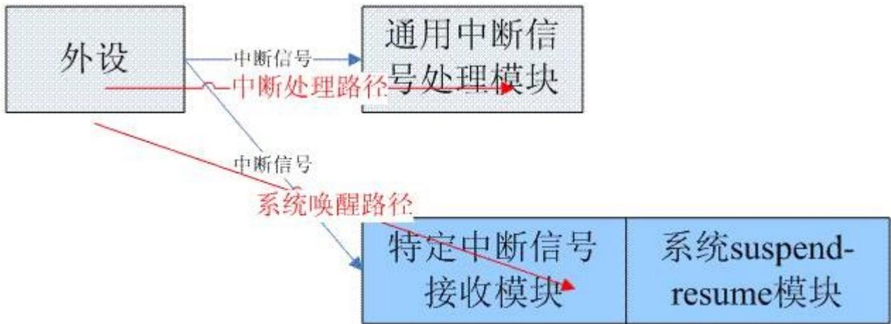
IRQ 子系统提供了两个接口函数来完成这个功能：enable\_irq\_wake()函数用来打开该外设中断线通往系统电源管理模块（也就是上面的 suspend-resume 模块）之路，另外一个接口是 disable\_irq\_wake()，用来关闭该外设中断线通往系统电源管理模块路径上的各种 HW block。
