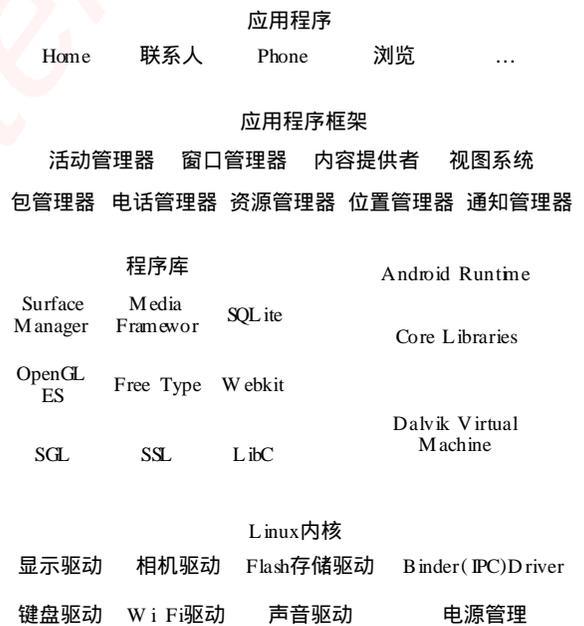
图 1 Android系统平台架构
