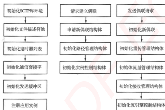
图 4 SCTP 协议初始化示意图
