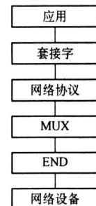
图 2 VxWorks网络系统结构
