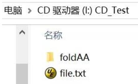
把它放到 VxWorks 的 Target 后, VxWorks 启动时自动加载 cdromFS, 然后可以使用 `open()`、`close()`、`read()`、`ioctl()`、`readdir()`、`stat()` 等函数来访问它。使用 `cdromFsVolConfigShow()` 可以查看 cdrom 的卷配置
