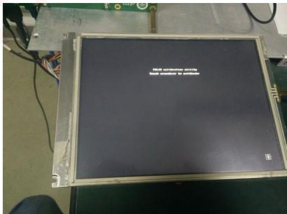
图 4-37 触摸屏控制板
