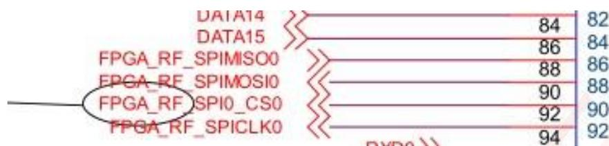
图 4-25 S5Pv210 与 Spartan 3 的 SPI 总线硬件原理图
