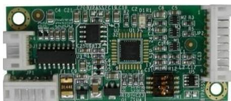
图 4-35 触摸屏控制板
