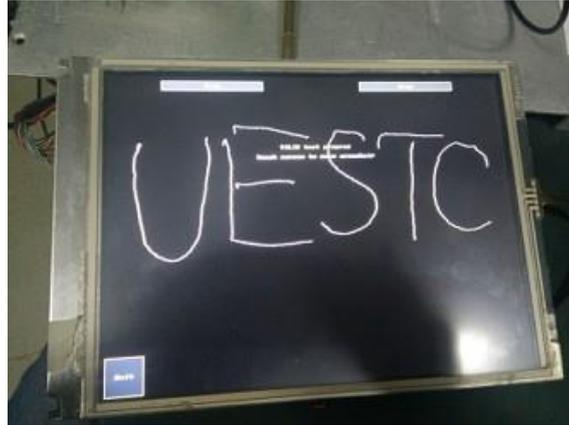
图 4-38 触摸屏控制板
