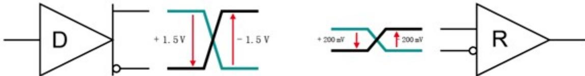
图 3：RS-485 规定的最小总线信号电平
