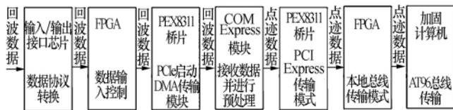
图 5 回波数据的传输流程图
