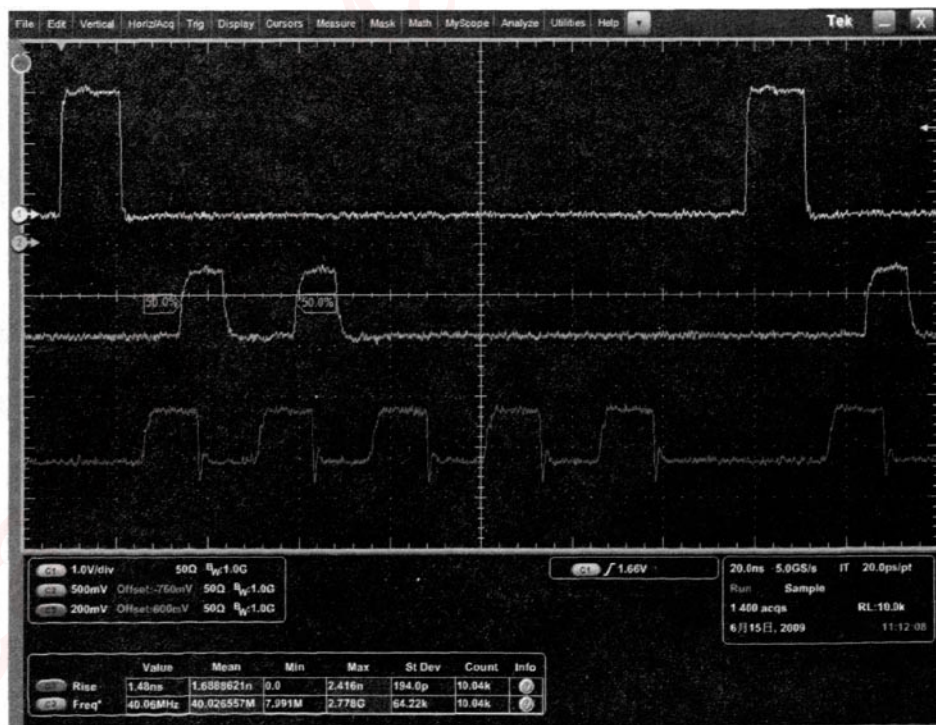
图5 40 MHz 群脉冲的远程控制输出波形
