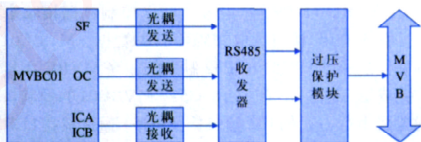
图 4 MVB 物理层接口电路
